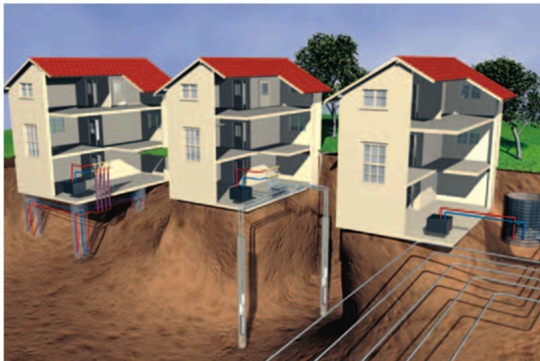
Există două tipuri de colectori care pot fi utilizati în circuitele intermediare de preluare a căldurii din sol :
